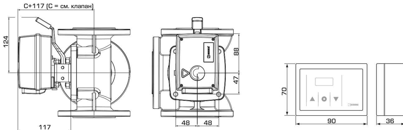
Установочные размеры для приводов серии CRC120 со смешительными клапанами ESBE серий MG, G, F, T/TM, H/HG и BV
