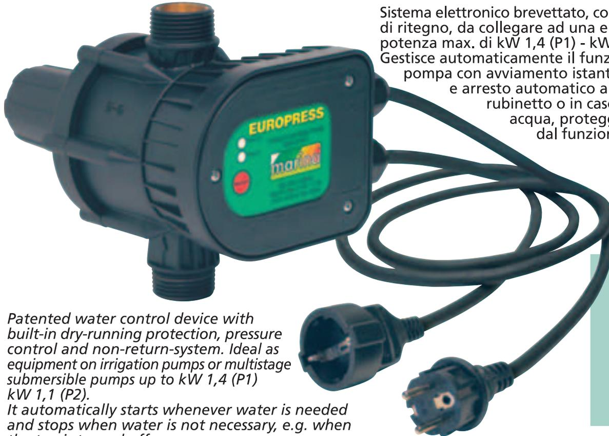
Sistema elettronico brevettato, completo di valvola di ritegno, da collegare ad una elettropompa con potenza max. di kW 1,4 (P1) - kW 1,1 (P2). Gestisce automaticamente il funzionamento della pompa con avviamento istantaneo all'utilizzo e arresto automatico alla chiusura del rubinetto o in caso di mancanza di acqua, proteggendo la pompa dal funzionamento a secco.
