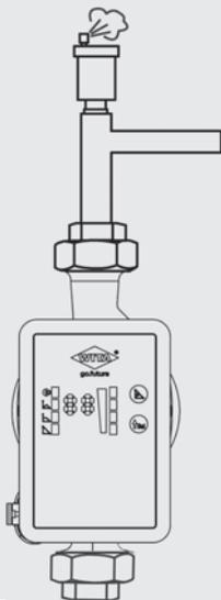
Anlage sachgerecht füllen und entlüften. Um die Pumpe zu entlüften, sollte das Entlüftungsprogramm gestartet werden. (siehe Abschnitt 7.6 auf Seite 14)
